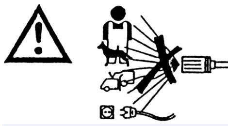
Der Hochdruckstrahl entwickelt eine Rückstosskraft an der Lanze. Daher muß der Griff an der Lanze gut festgehalten werden.
