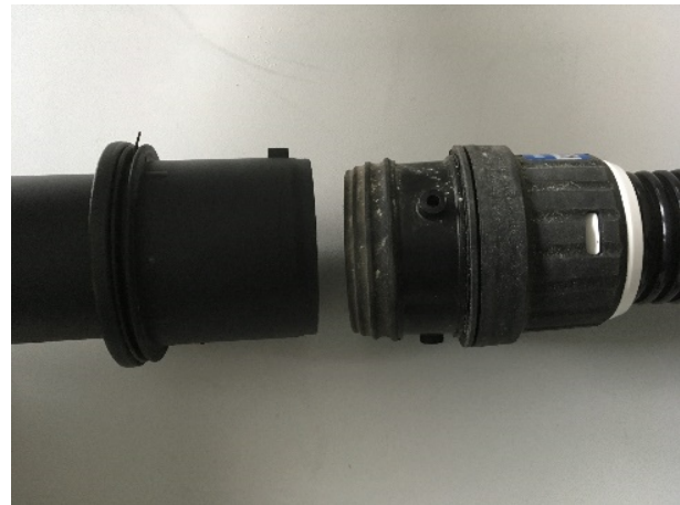
Bild 3: links: Anschlussmuffe Kärcher alt (Bajonett 1.0) mit einer Rastnase, rechts: Kärcher neu (Bajonett 2.0) mit drei Rastnasen und geänderter Ausbildung. [Walter Gunreben - BG BAU]
