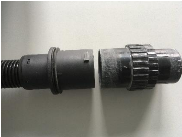
Bild 2: links: Anschlussmuffe Kärcher alt (Bajonett 1.0) mit einer Rastnase, rechts: Anschlussmuffe für Entstauber mit 57/58 mm Konus. [Walter Gunreben - BG BAU]
