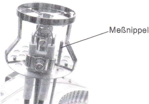
Zusammenbau in umgekehrter Reihenfolge. Dabei bei GG55 auf Position des Meßnippels achten (kleine Bohrung in der Stauscheibe, Kennzeichnung „M“).
