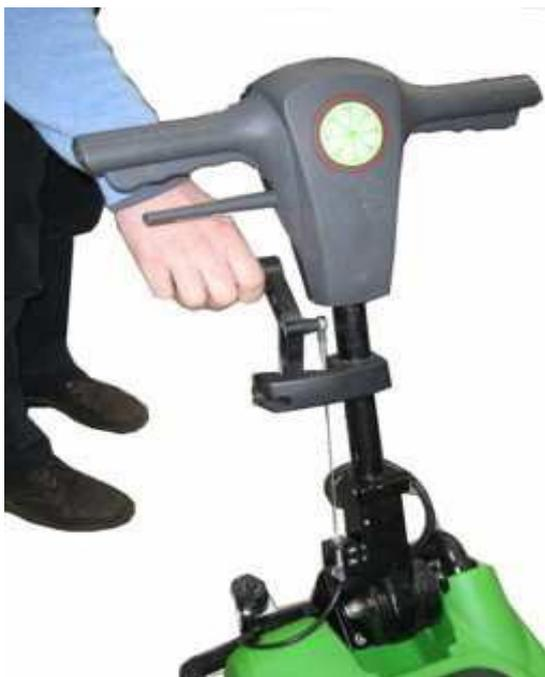
4. Hahn des Reinigungsmittel tanks öffnen.
