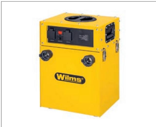
Abscheider für Wasser / Feststoffpartikel im robusten Metallgehäuse mit Sauganschluss für 38 mm und 50 mm Schlauchsysteme, sowie zwei Zusatzsteckdosen zum Anschluss von max. zwei Verdichtern.
